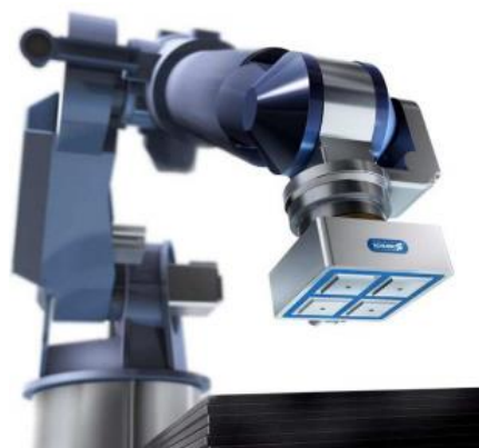
Obr. 2.5 – Magnetický koncový efektor (Bernier, 2014)
