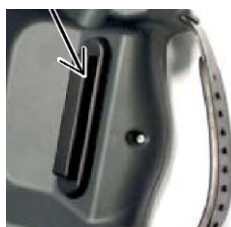
Obr. 6.17 – Blokovací mechanismus (CS8C Kontrolér, 2016)
