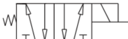
Obr. 3.9 – (5/2) monostabilní elektricky ovládaný ventil s tlačítkem (Ventily, 2010)
