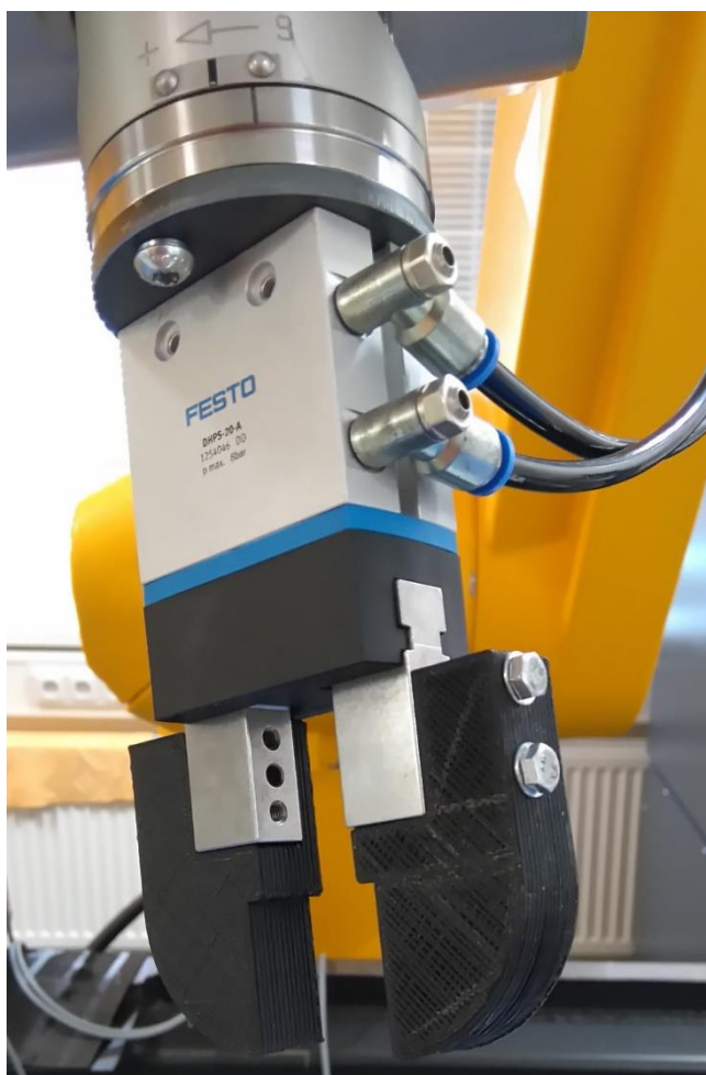
Obr. 4.5 – Paralelní efektor DHPS20-A včetně externích palců
