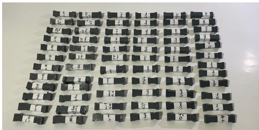
Obrázek 25 – Fotografie testovacích těles vytištěných pomocí nevodivého filamentu
