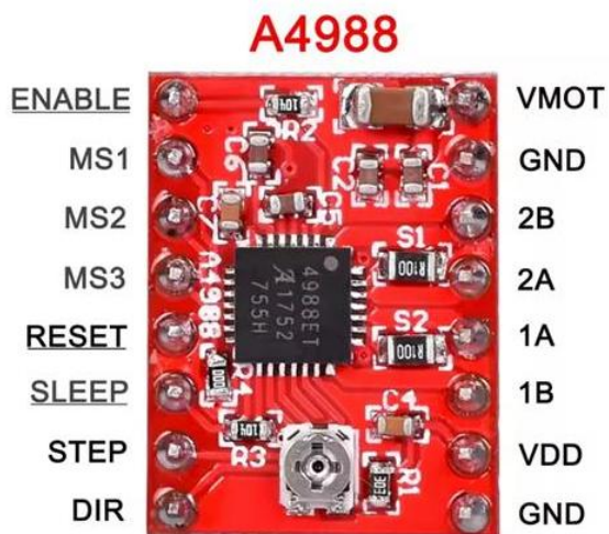
Obrázek 4: Piny driveru A4988
