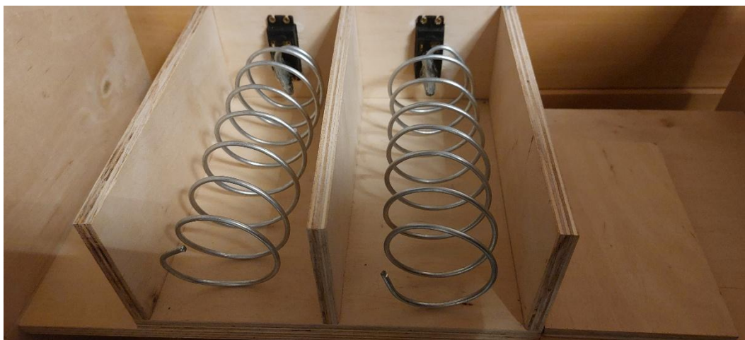
Obrázek 13: Výdejní box s přidělanou pružinou
