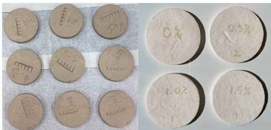
Obrázek 13 – Dlaždice s obsahem CN před (nalevo) a po vypálení (napravo) [104]
