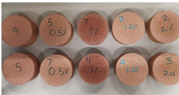
Obrázek 12 – Vzorčky hliněných cihel s obsahem CN [103]
