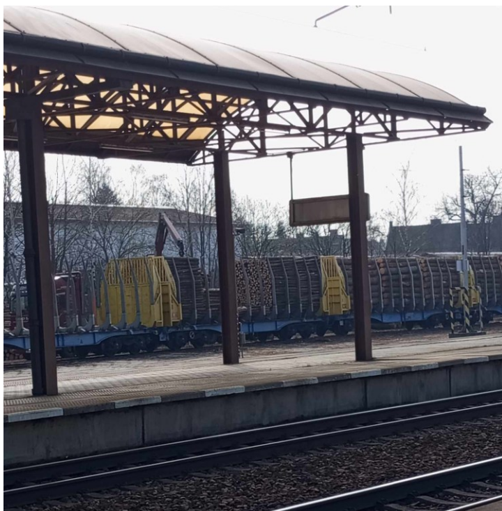
Obrázek 11 Nakládání nástaveb GigaWood ve stanici Svitavy (zdroj: autor)
