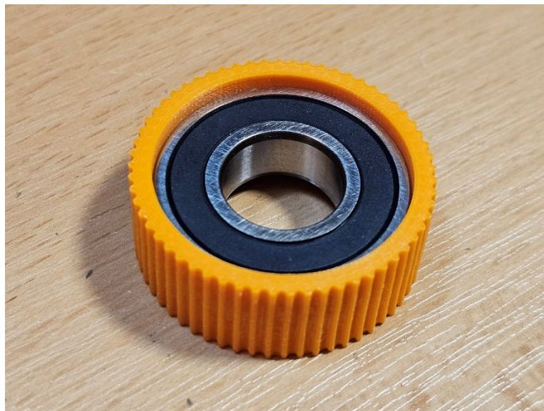
Obrázek 31: Ložisko 6002 nalisované v ozubeném kole
