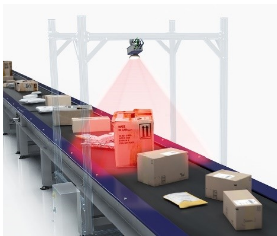
Obrázek 6 Stacionární čtečka nad dopravníkovou linkou (Datascan.cz 2025)
