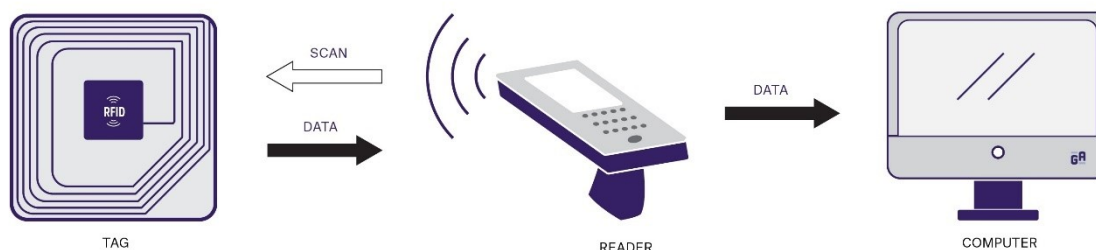
Obrázek 3 Schéma fungování technologie RFID (Labtag.com, 2024)
