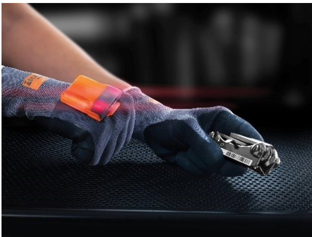
Obrázek 8 Chytrá pracovní rukavice s integrovanou čtečkou čárových kódů (ProGlove.webnode.cz 2025)
