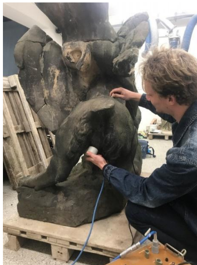
Obrázek 9 průběh měření signálu ultrazvuku
