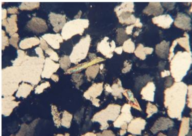
Pískovec křemenný, stř. zrnitý s HZ příměsí, slabě silicifikovaný vzorek JZ-1, skála, zvětšení 32x, nikoly X, \phi 0,84x0,31 max., \phi 0,12 sf. min., zmitost a nedokonalé opracování Q klastů, přítomnost klastické slidy (muskovit)
