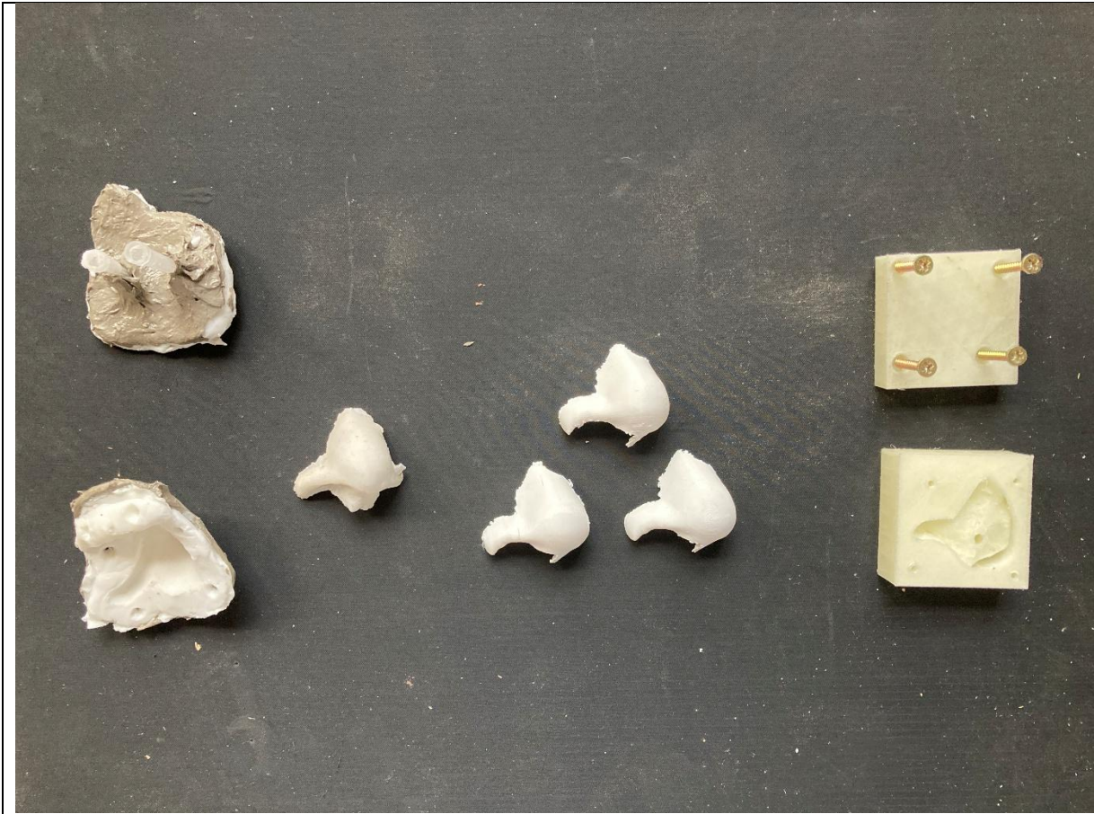
A, Zleva silikonová forma s výsledným doplňkem, B, tisknuté modely C, tisknutá forma
