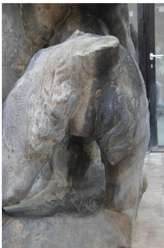
Obrázek 37 vlevo průběh redukce zčernalého povrchu, vpravo nabourávání sádrovcové krusty zábalení buničiny s 10 % roztokem uhličitanu amonného
