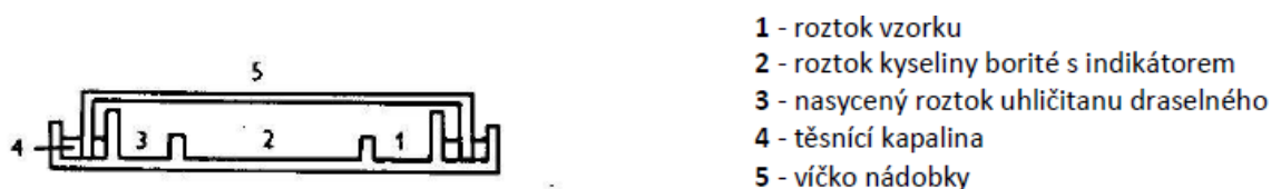
Obrázek 14 Conwayova nádoba na stanovení amoniaku mikrodifuzí [38]
