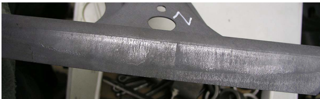
Obr. 47: Profil materiálu USI - povrchová vada v horní oblasti B-sloupku
