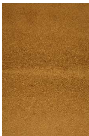
Obr. 38: Heterogenita ve středovém pásmu materiál BTR (zvětšeno 100x)
