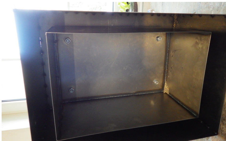
Obr. 5 – Konstrukce 5 – uložení vnitřní muflle na distanční šrouby
