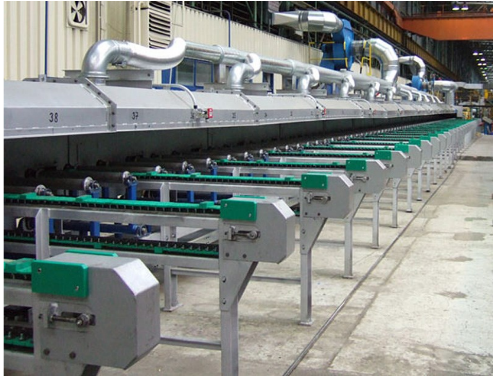
Obr. 1.11 – Válečková pec (Ethermtz, 2015)
