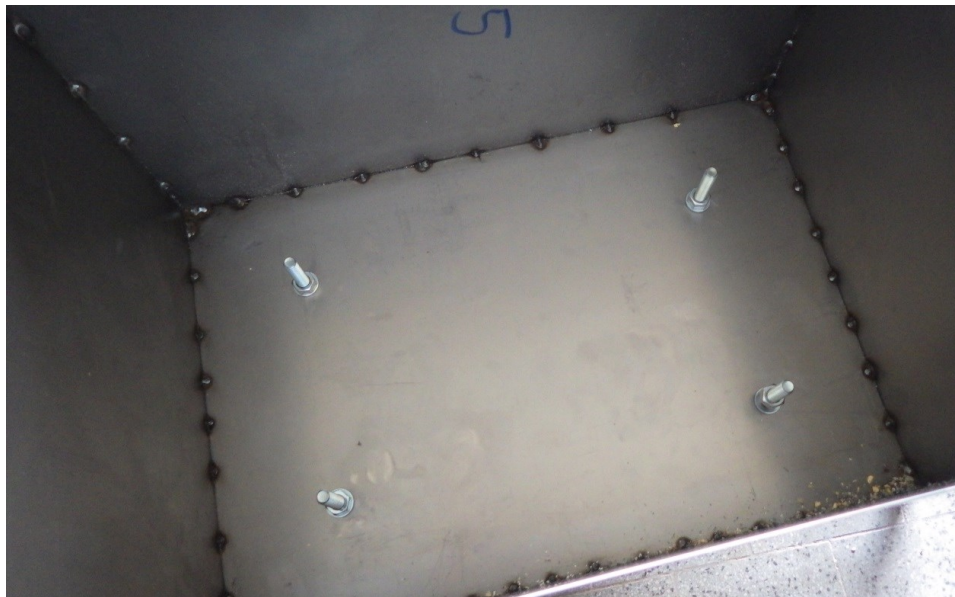
Obr. 1 – Konstrukce 1 – distanční šrouby (50mm)
