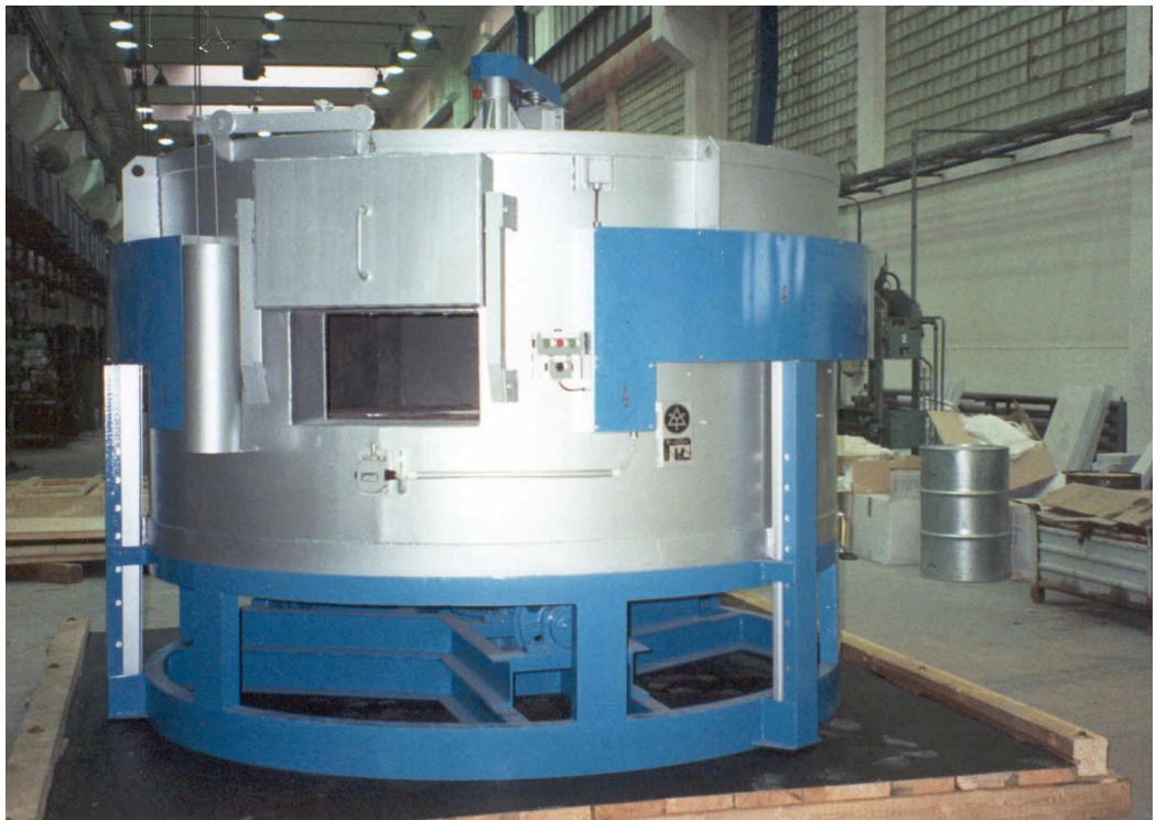
Obr. 1.12 – Karuselová pec (Zez Praha, 2015)
