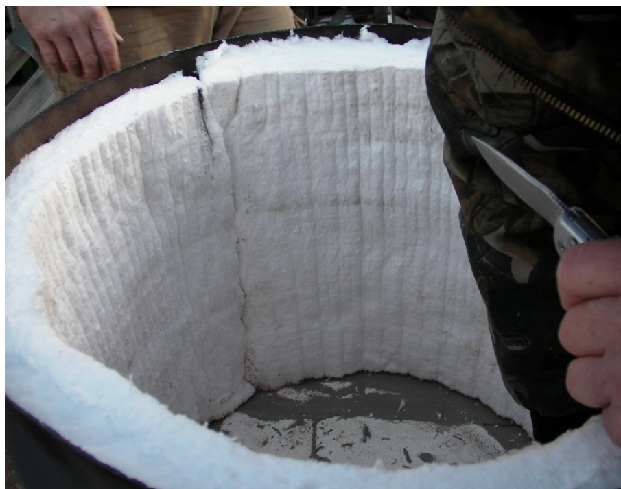
Obr. 1.16 – Použití materiálu Cerablanket (Submarineboat, 2015)
