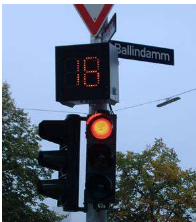
Obr.2 Odpočet u světelného signalizačního zařízení
