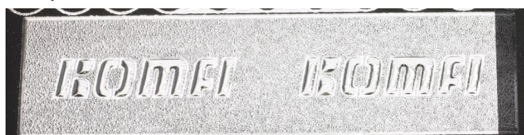
Obrázek 25 – Detail parciálního laku a 2,5D písma – fólie ALUFIN SCODIX 351, teplota 180 °C, rychlost 5 m/min, lak 240 HDC, kvalita hodnocena stupněm 1
