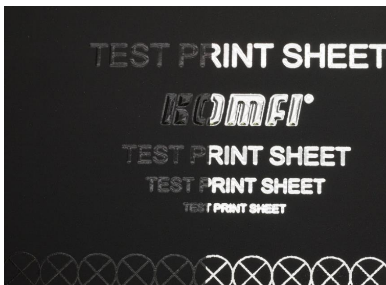
Obrázek 21 – Úzká šíře metalické fólie na potiskovaném materiálu – fólie KURZ LUXOR MSU 220, teplota 180 °C, rychlost 5 m/min, lak 240 HDC
