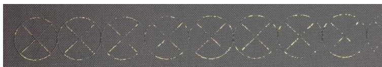
Obrázek 28 – Detail tenkých linek – fólie Foilco 6916 NB, teplota 150 °C, rychlost 5 m/min, lak 240 HDC, kvalita hodnocena stupněm 5
