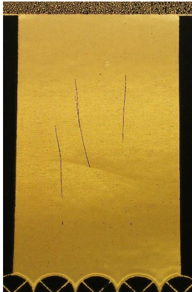
Obrázek 30 – Test odolnosti proti poškrábání – fólie Foil Industry 41V1014, teplota 170 °C, rychlost 5 m/min, lak 240 HDC, kvalita hodnocena stupněm 2
