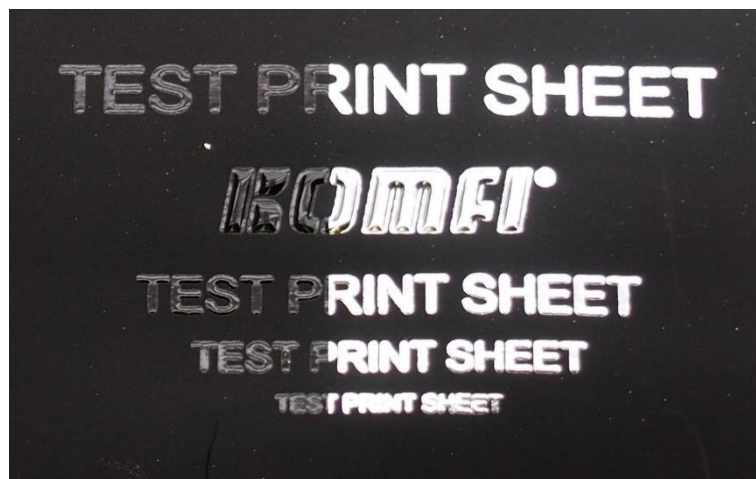
Obrázek 22 – Detail 2D a 2,5D písma – fólie ALUXIN SCODIX 351, teplota 180 °C, rychlost 5 m/min, lak 240 HDC, kvalita hodnocena stupněm 1
