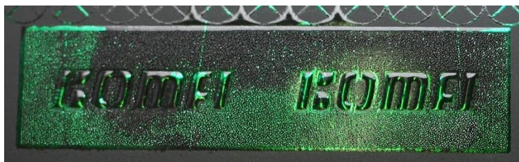
Obrázek 26 – Detail parciálního laku a 2,5D písma – fólie Foilco 6010 RTX, teplota 150 °C, rychlost 10 m/min, lak 240 HDC, kvalita hodnocena stupněm 5
