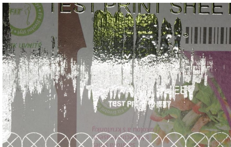
Obrázek 20 – Chybné nanesení laku na potiskovaný materiál – fólie FR 33/SXC 1000, teplota 180 °C, rychlost 5 m/min, lak 240 HDC
