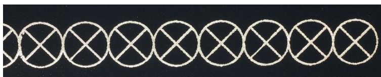
Obrázek 27 – Detail tenkých linek – fólie FR 41/ZF, teplota 180 °C, rychlost 5 m/min, lak 240 HDC, kvalita hodnocena stupněm 1
