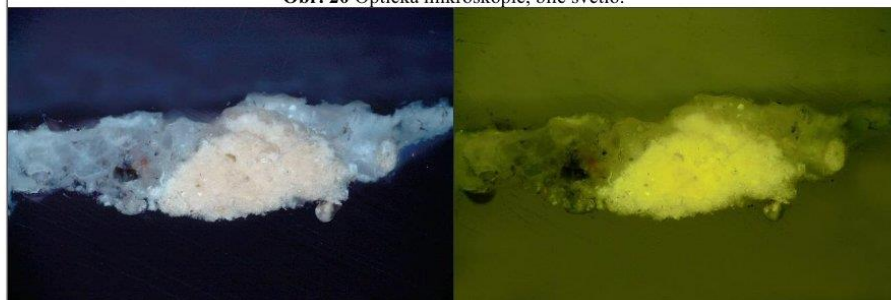
Obr. 21, 22 Luminiscenční mikroskopie: UV luminiscence/VIS luminiscence generovaná modrým světlem.
