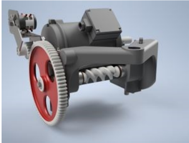
Obr. 5 - 3D model přestavného ústrojí přestavníku EP 600, [2]
