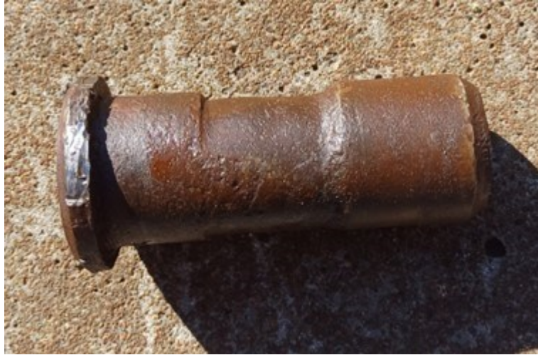
Obr. 27 - omačkaný čep, detail
