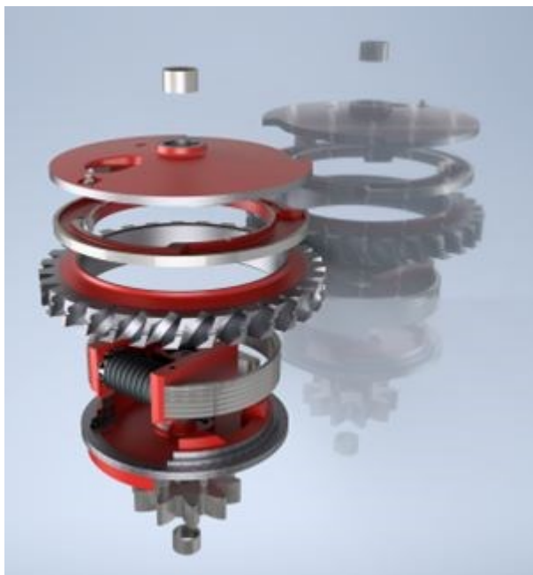
Obr. 6 - spojka přestavníku EP 600, 3D model, [2]
