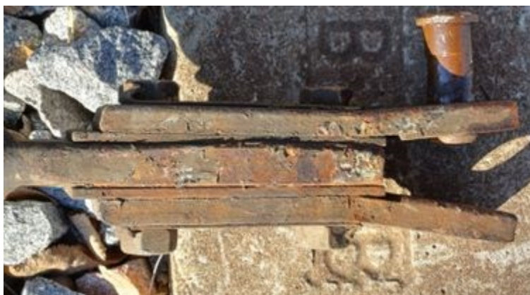
Obr. 26 - pokřivená přestavná tyč a omačkaným čepem
