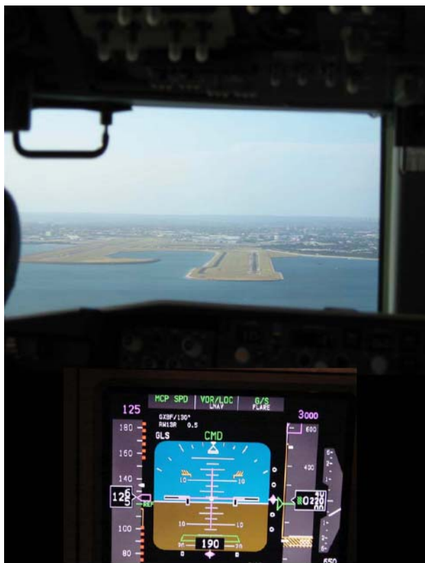
Obr. 7 Letoun B737NG vybavený prostředky pro přesné přiblížení kategorie CAT I s využitím GBAS provádí sestup na letiště Sydney
