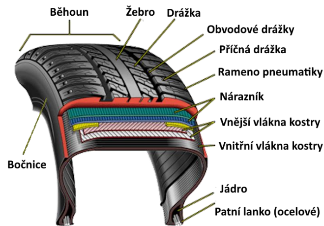
Obrázek 3 - Části pneumatiky. [4]
