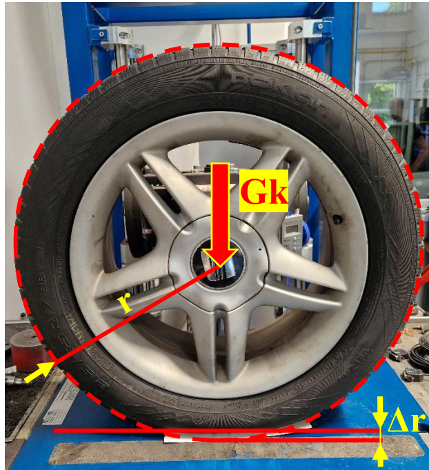
Obrázek 12 - Znáznornění radiálního zatížení a deformace na pneumatice. (archiv autora)
