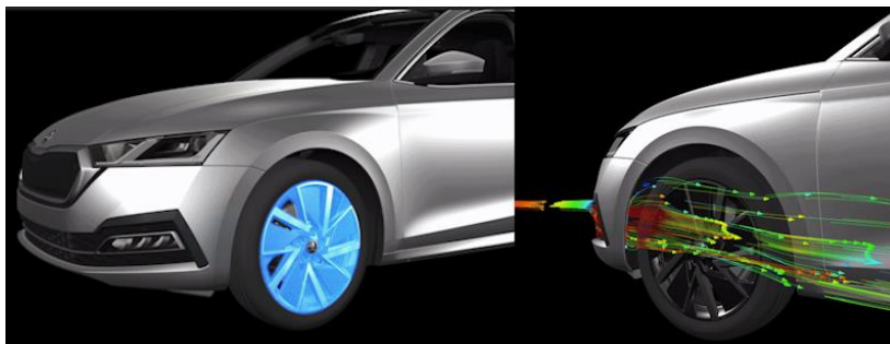
Obrázek 20 - Aerodynamické kryty kol / proudění vzduchu za použití krytů. [42]
