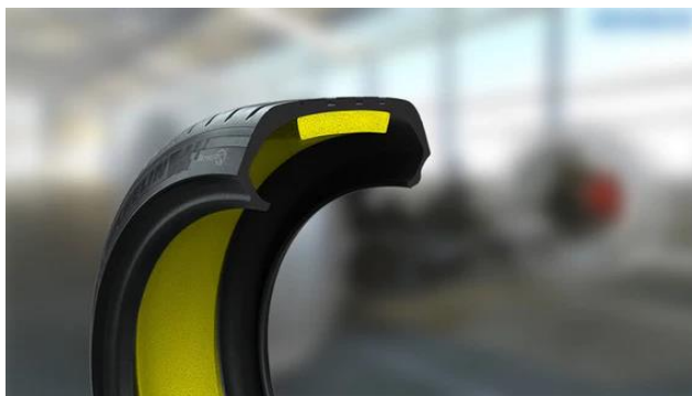
Obrázek 16 - MICHELIN® Acoustic Technology – pěnový pás uvnitř pneumatiky.[34]
