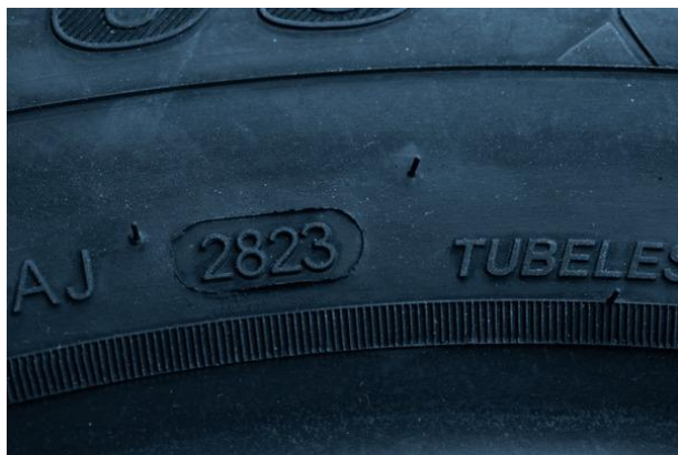
Obrázek 6 - DOT kód data výroby pneumatiky. [8]
