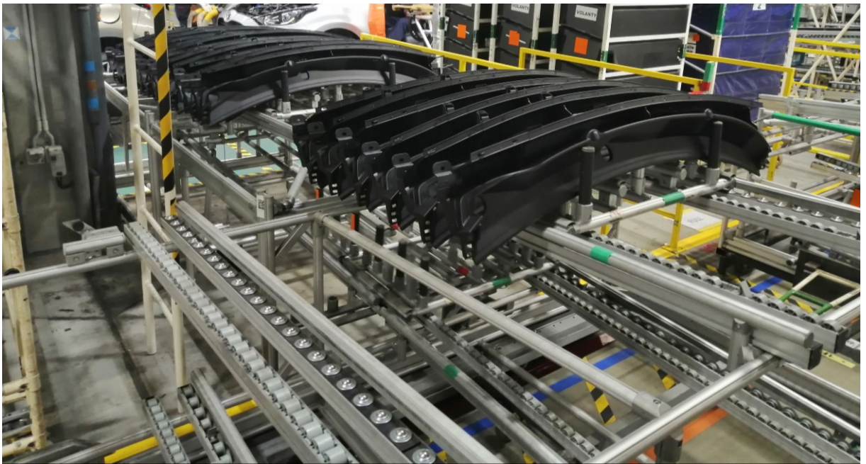
Obrázek 19 Přepouštění dílu A na linku pomocí Karakuri vozíků (autor)
