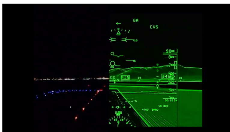
Obrázek 5: ukázka systému CVS (Combined Vision System) od Collins Aerospace
