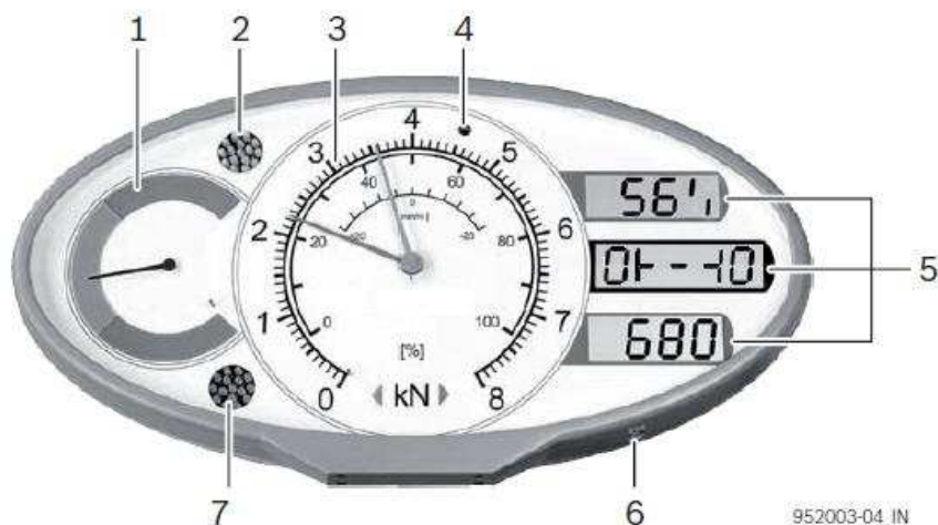
Obr. č. 20: Zobrazovací prvky analogového ukazatele 8 kN
