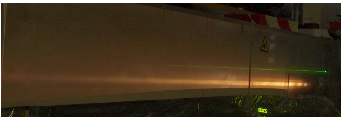
Obrázek 34 - Vodní mlha během měření útlumu spektroskopem, zelený laser měří dohlednost
