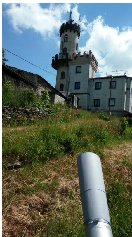
Obrázek 57 - Zařízení pro měření pohybu paprsku, dole vysílač, přijímač na věži
