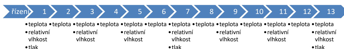
Obrázek 43 - Diagram rozmístění různých typů čidel podél optického spoje
