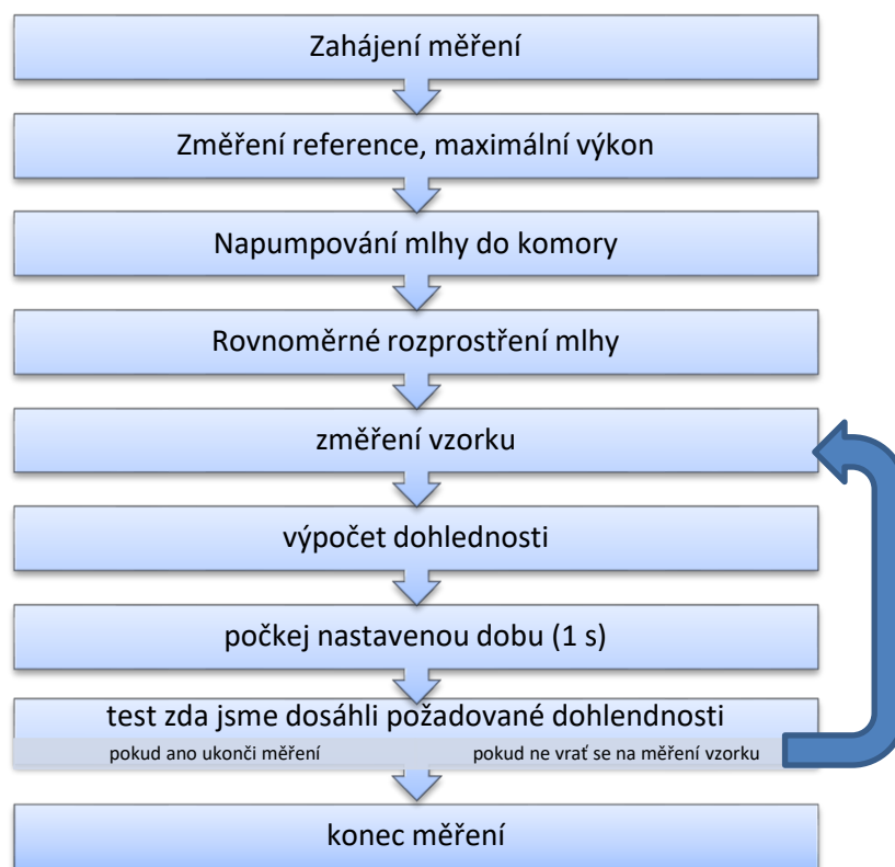
Obrázek 28 - Vývojový diagram měření útlumu v komoře
