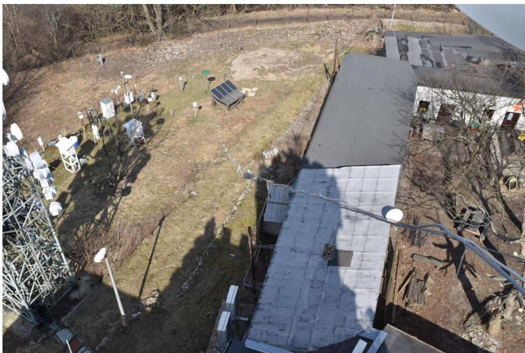
Obrázek 44 - Pohled na zahrádku observatoře, ocelové lanko nese čidla měřícího zařízení
