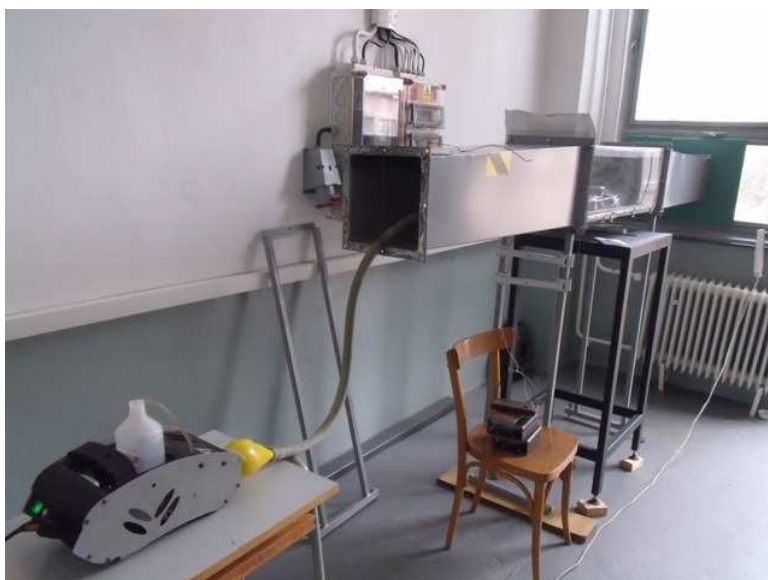
Obr.28 - Úpravy vzduchové tratě pro experiment s mlhovinou
