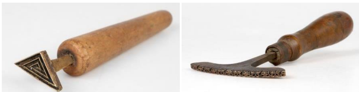
Obrázek 200 Slepotiskové nástroje z dílny J. Rajmana, zleva: tlačítko s geometrickým motivem, fileta s florálním ornamentem (sbírka Nadačního fondu Jendy Rajmana)
