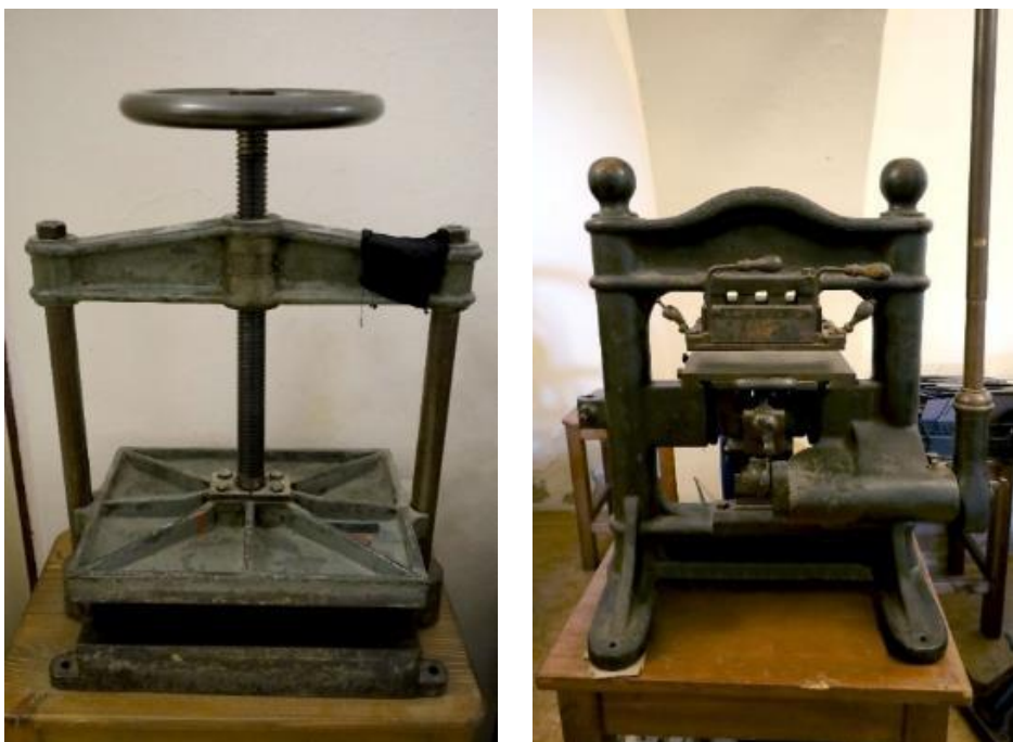
Obrázek 22 Vřetenový lis firmy V. Vajsar a Spol. (vlevo) a zlatí lis (vpravo) v Rožďalovické dílně
