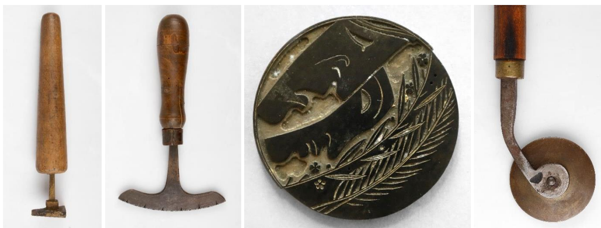
Obrázek 199 Ukázky slepotiskových nástrojů z dílny J. Rajmana, zleva: tlačítko, fileta, plotna a rolna (sbírka Nadačního fondu Jendy Rajmana)
