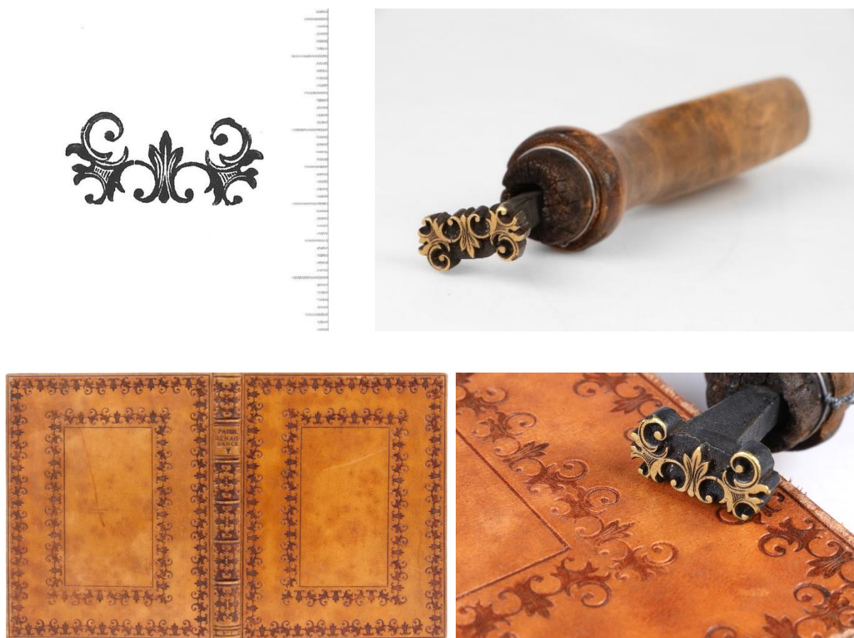
Obrázek 213 Tlačítko (původní ozn. 211) s vegetabilním motivem a ukázka použití na knižní vazbě z roku 1914 titulu Renaissance (vazba ze soukromé sbírky Ivana Kopáčika)
