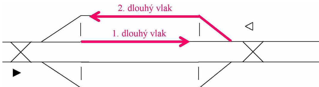
Obrázek 57 Dopravna poskytující v sudém směru schéma C a v lichém směru schéma A
