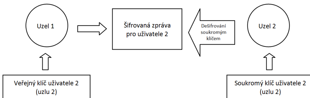
Obrázek 12 - Princip asymetrického šifrování a dešifrování [4]
