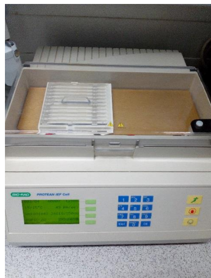
Obrázek č. 17: Zleva Mini-Protein® Tetra cell system určený na elektroforézu, vpravo přístroj Protean IEF Cell určený na izoelektrickou fokusaci (obojí Biorad, ČR)
