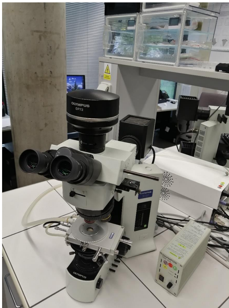
Obrázek 5 Optický mikroskop OLYMPUS BX51, vybavený optickou kamerou DP72 a integrovaným temperačním stolcem LINKAM
