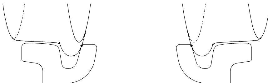
Obr. 5 Nep ıijateln e postaven ı dvojkol ı v koleji za mezi vzp r ıcen ı dvojkol ı ve voln m j zdn m kan lu (kolejnice typu NT1 R10 , rozchod koleje 1435 mm,  hel n b ehu dvojkol ı 5,16 , rozkol ı 1380 mm, j zdn ı obrys DPMB-004)
