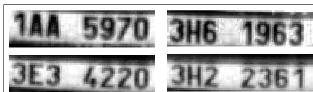
Obrázek 23- RZ po vertikálním oříznutí
