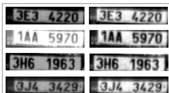
Obrázek 25- RZ před ekvalizací (vlevo), po ekvalizaci (vpravo)
