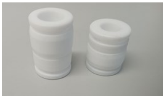
Obrázek 11: Porovnání mikroelektrodialyzerů. 1500 \mu l (vlevo) a 250 \mu l (vpravo).
