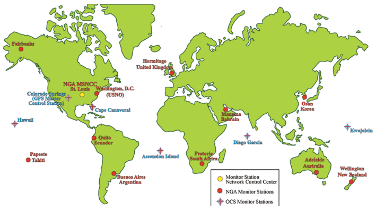
Obrázek 7 - Rozmístění stanic řídicího segmentu (zdroj: [7])
