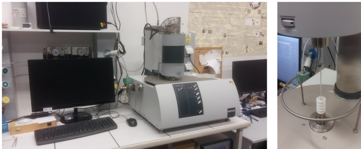
Obrázek 34 Přístroj pro simultánní termickou analýzu (vlevo) a pohled na měřící celu (vlevo) (autor)
