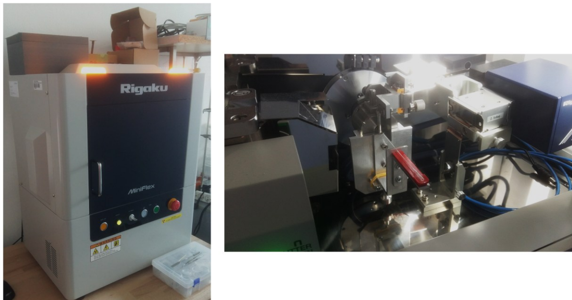
Obrázek 36 Rentgenový difraktometr pro práškové vzorky (vlevo) a pohled na kapilární měření (vpravo) (autor)
