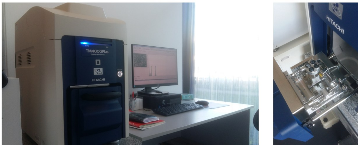
Obrázek 37 Skenovací elektronový mikroskop (vlevo) a pohled na měřící celu (vpravo) (autor)
