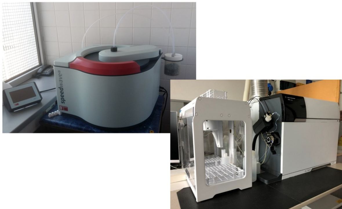
Obrázek 35 Mikrovlňnný reaktor (vlevo) a ICP-MS (vpravo) (autor)
