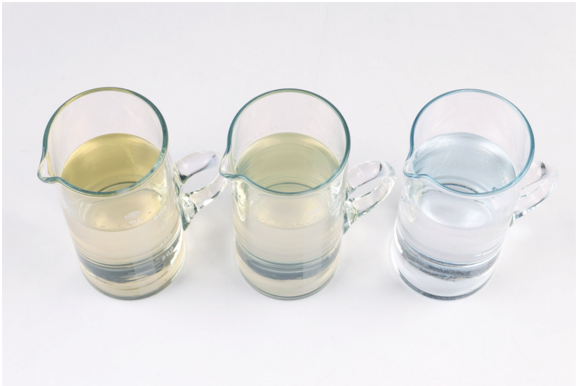
Obr. 56 Vyplavené nečistoty po prvom nároku a výplachu, vpravo čistá voda
