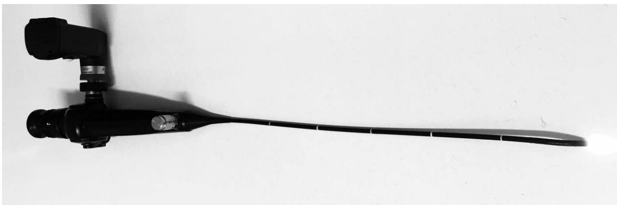
Obrázek 31 Flexibilní endoskop (fotografie vlastní)
