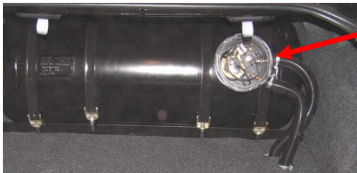
Obr. 3.4 – Plynotěsná skříň - provedení s válcovou nádrží [8], [9]
