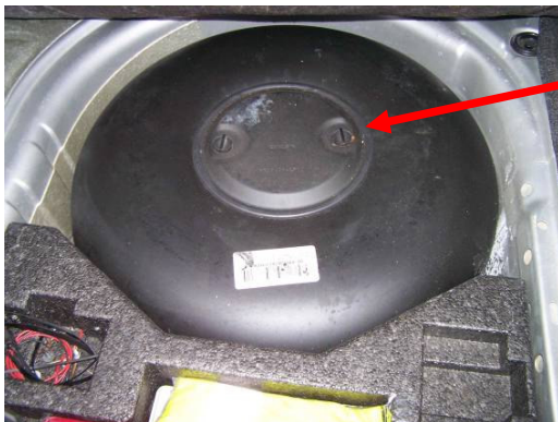
Obr. 3.5 – Plynotěsná skříň - provedení s toroidní nádrží
