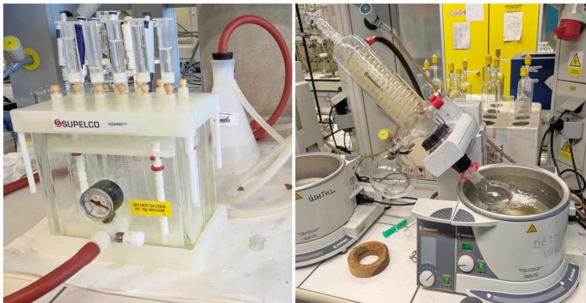
Obrázek 21: Vakuová aparatura s SPE kolonkami (vlevo) a zařízení pro rotační vakuovou destilaci (vpravo).
