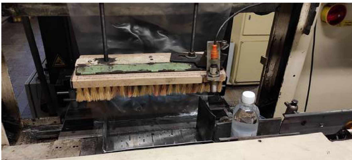
Obrázek 2.6: Přídržné kartáče s optickým čidlem počítání
