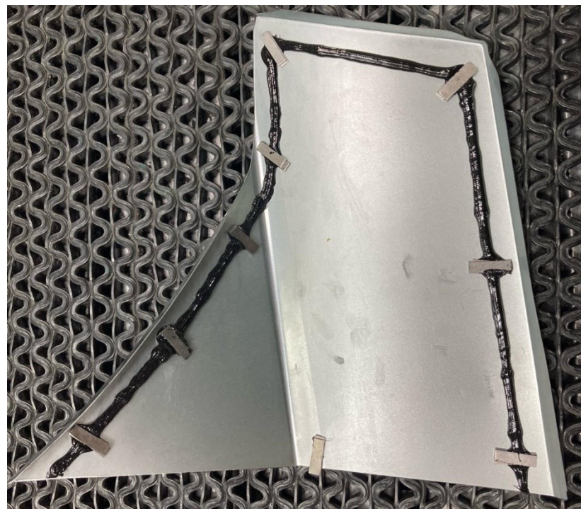
Obr. 36 Vzorek s tlumícím tmelem a plíšky
