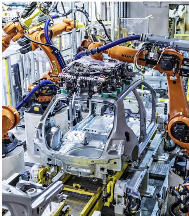
Obr. 8 Ukázka robotického svařování ve Škoda Auto [13]
