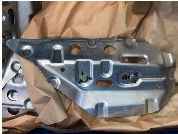
Obr. 22 Jeden z výztužných dílů kapoty
