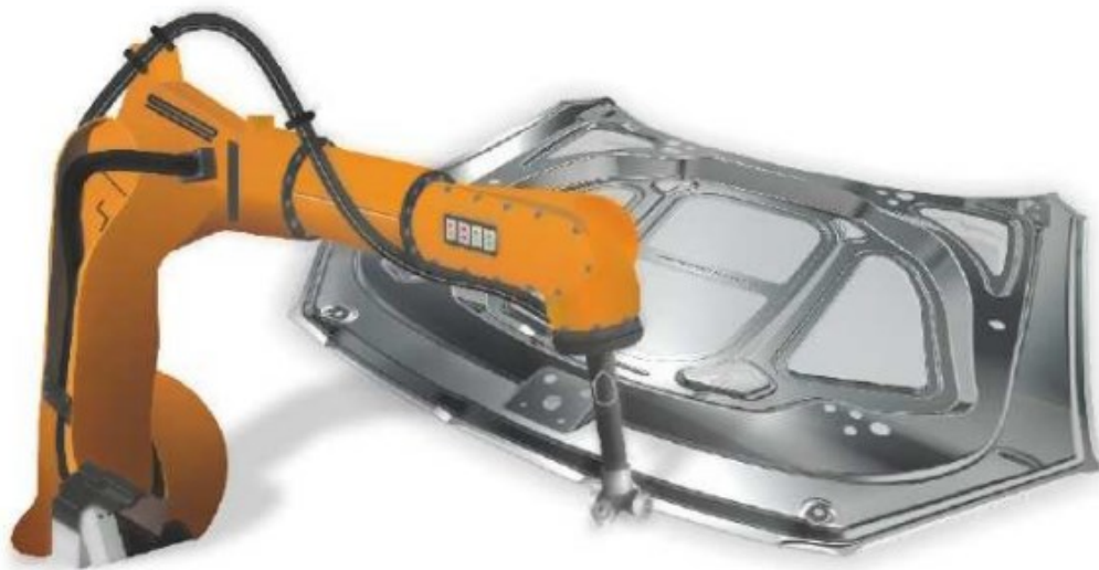
Obr. 26 Princip lemování rolnou [16]
