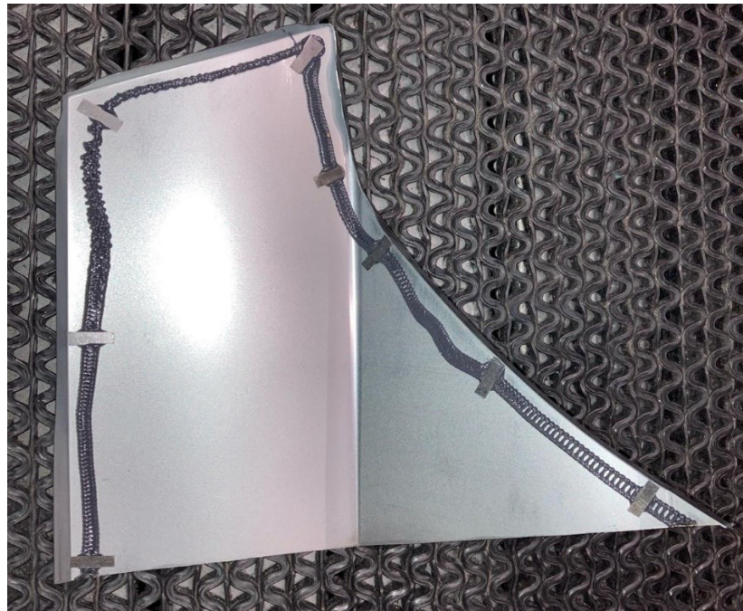
Obr. 35 Vzorek s lemovým lepidlem a plíšky
