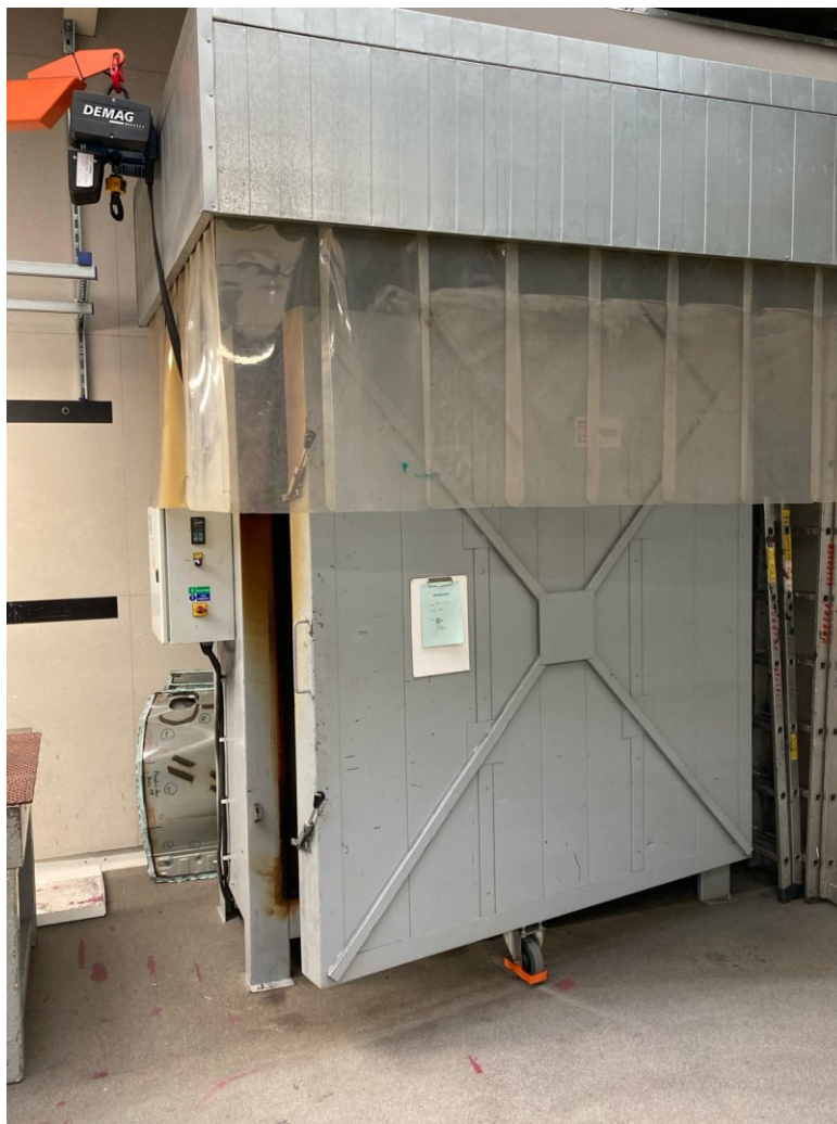
Obr. 40 Průmyslová komorová pec použita pro vytvrzení lepidel
