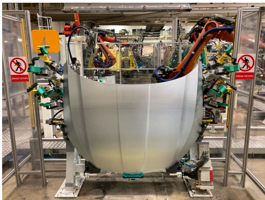
Obr. 29 Vnější díl kapoty uložený v přípravku
