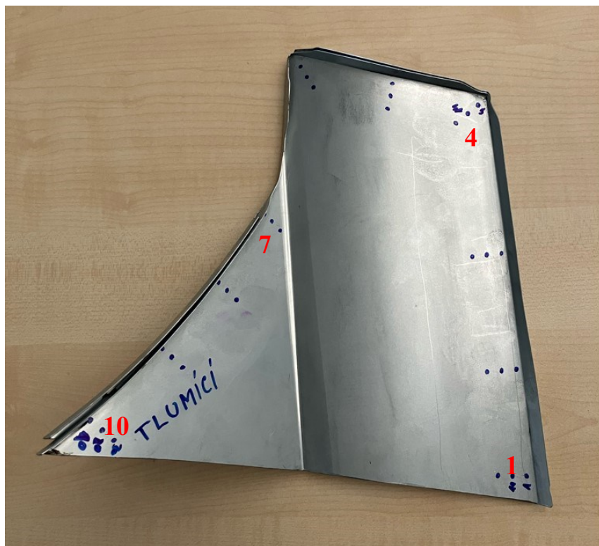
Obr. 38 Měřicí body na vzorku s tlumícím tmelem
