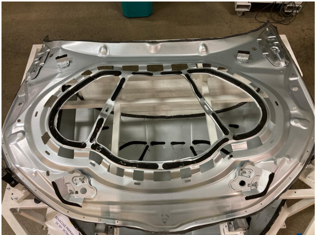
Obr. 25 Vnitřní díl s výztuhami a naneseným lepidlem
