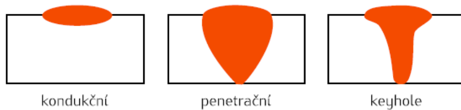
Obr. 7 Typy laserového svařování [12]
