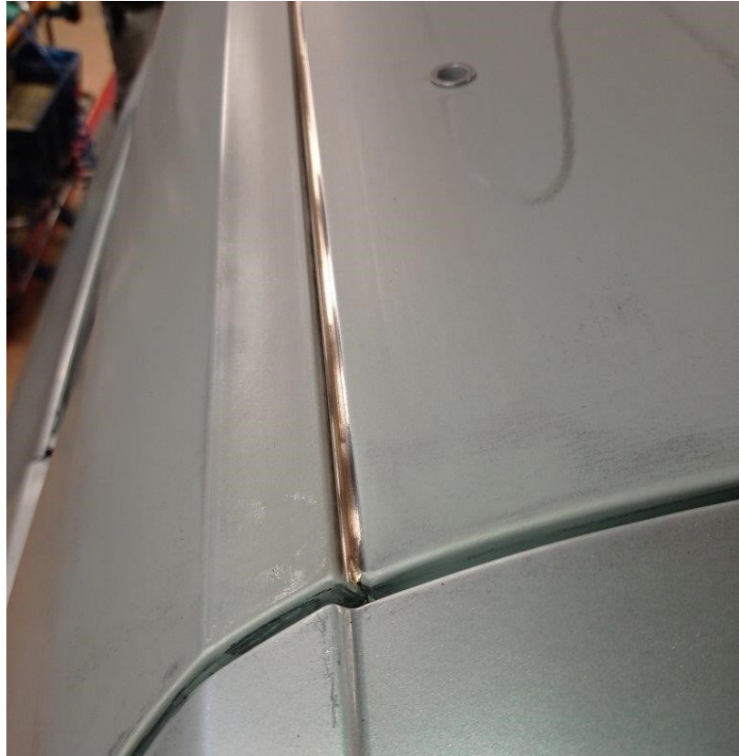
Obr. 12 Svarový spoj po svařování laserem
