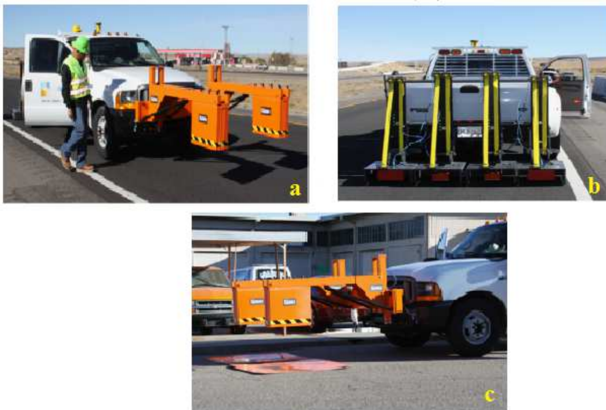
Obr. 14 – Průzkum GPR na přístrojové části vozovky: a) 2- 2,2GHz ground-coupled anténa, b) ground-coupled antény (400 – 900MHz), c) Bumper jump test
