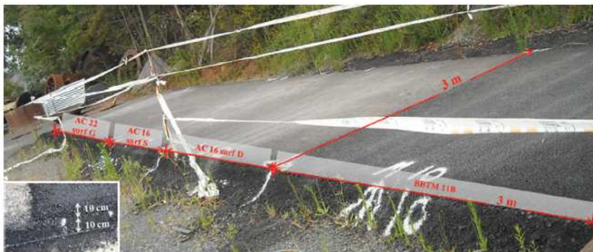
Obr. 12 – Zkušební úsek pro vyhodnocení nejistoty 1GHz antény
