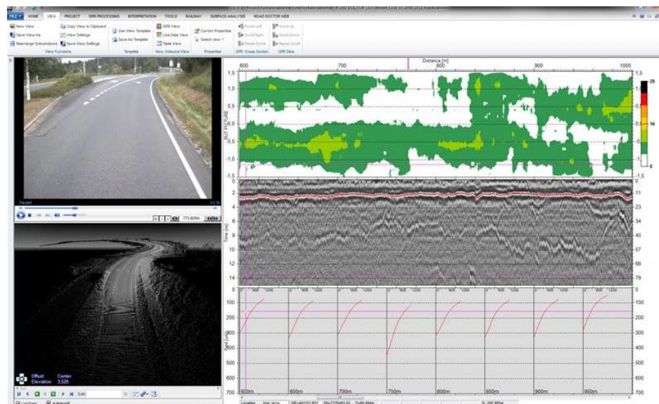
Obr. 15 - Zobrazení softwaru Road Doctor – výsledky měření laserového skenování, georadaru a rázového zařízení FWD
