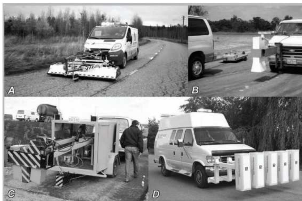
Obr. 6 - Různé GPR systémy a konfigurace antény použité v silničních průzkumech.
