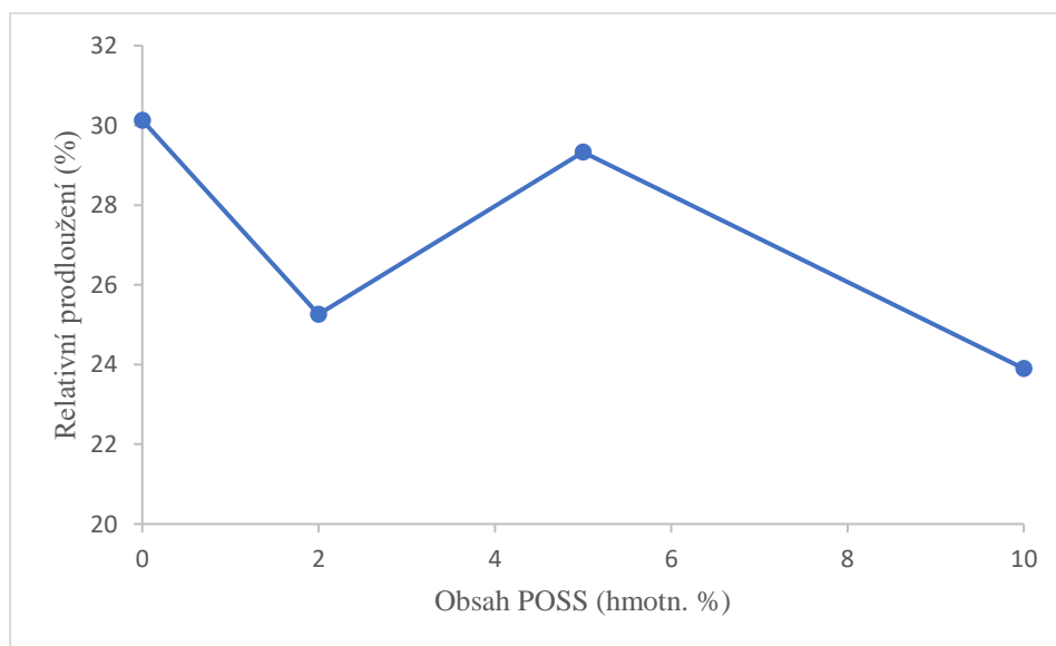
Obrázek 22: Změna relativního prodloužení s rostoucím obsahem APOSS. Směrodatná odchylka měření nepřekročila 3 %.
