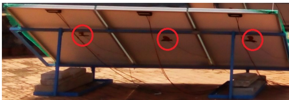
Obrázek 29 - Umístění teplotních senzorů na středu zadní části PV panelů
