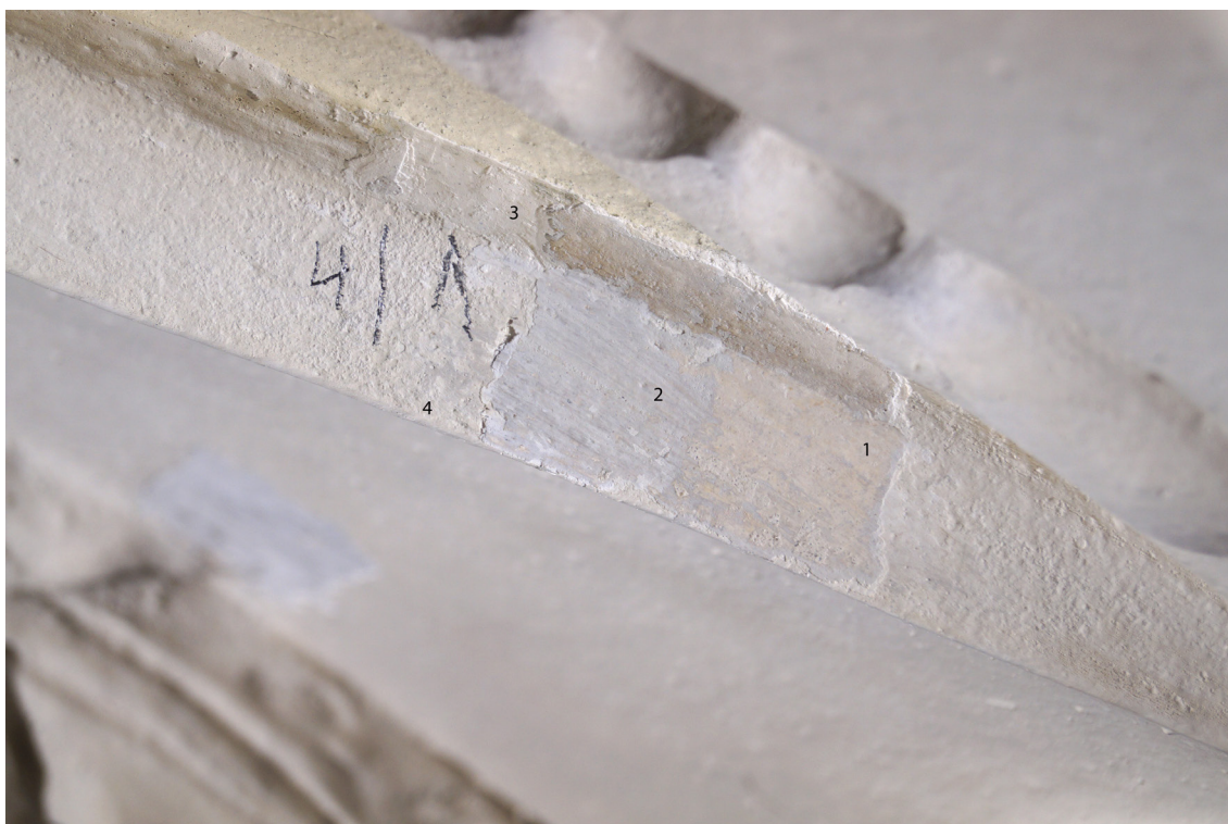
Obr 40 Sonda č. 4/1 - výběh voluty na rámu zrcadla 1. „režný“ velmi světlý a hladký povrch štuk, 2. tenký světlešedý nátěr 3. bílá vápenná 4. poslední silná plněná bílá
