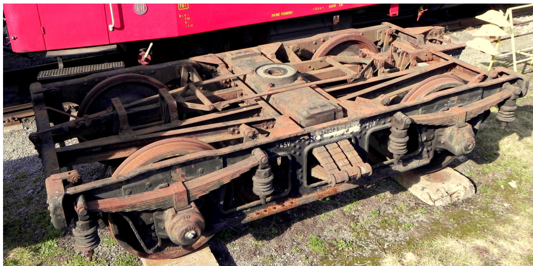
Obr. 4. Středoevropský podvozek KkStB If pocházející ze služebního vozu řady Fa
