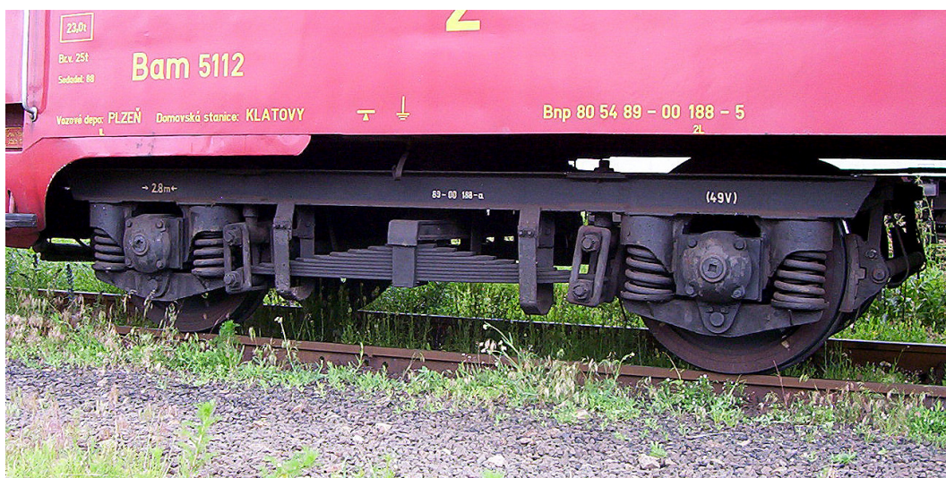
Obr. 13. Podvozek lehké konstrukce zavázaný pod vozem řady Calm
