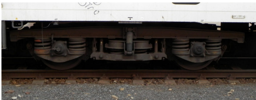
Obr. 26. Podvozek řady Görlitz Va zavázaný pod vozem řady B Českých drah (ČD)
