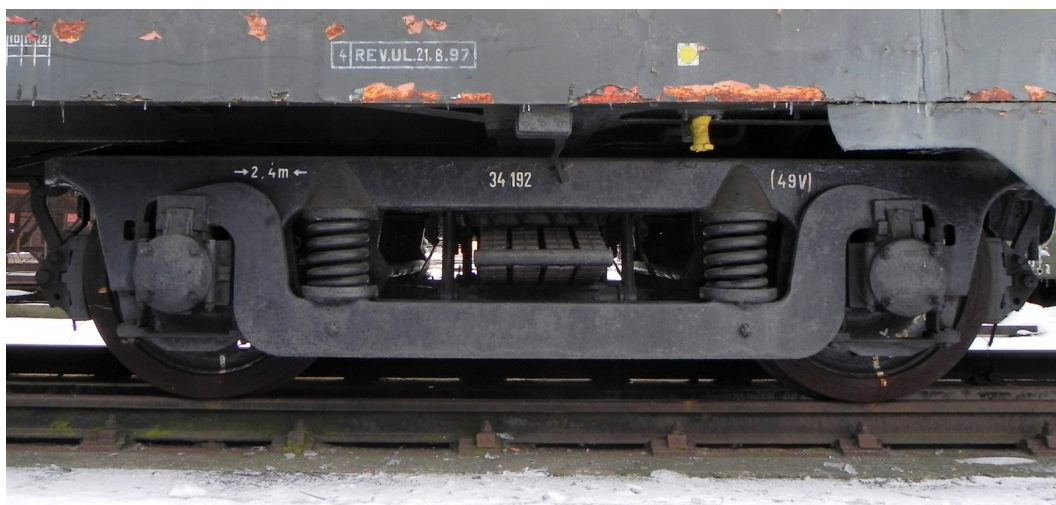
Obr. 6. Podvozek se jhy zavázaný pod vozem řady ABa
