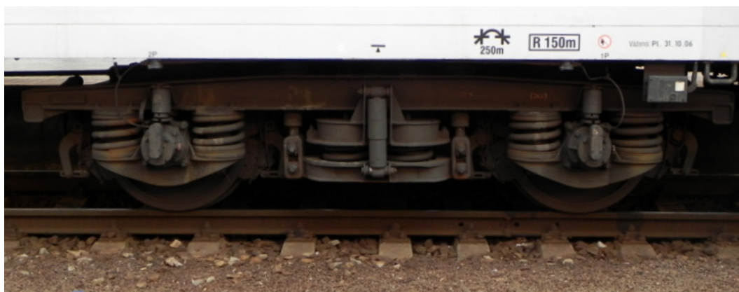
Obr. 25. Podvozek řady Görlitz V vozu řady A Českých drah (ČD) s hraníkovými závěsy kolébky a tlumiči primárního stupně vypružení
