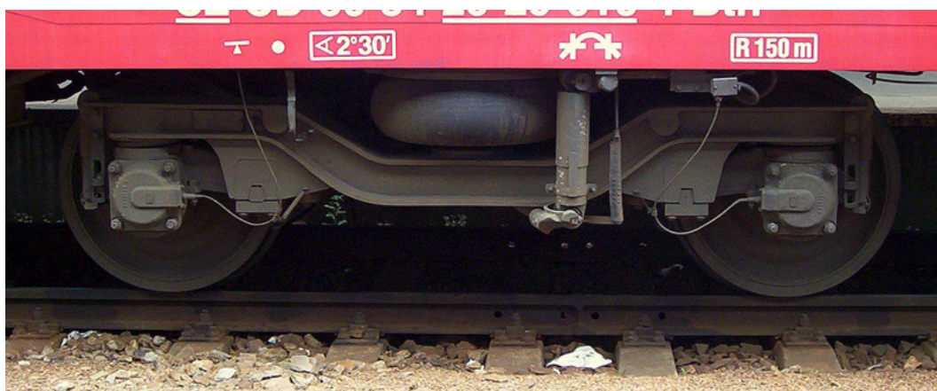
Obr. 45. Podvozek řady VÚKV 8-833 zavázaný pod vozem Btn Českých drah (ČD)
