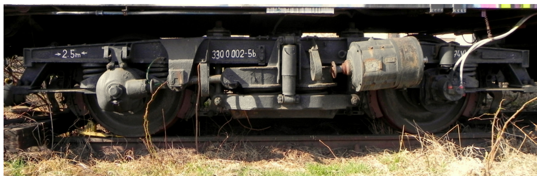
Obr. 28. Podvozek Görlitz VI o rozchodu 1435 mm zavázaný pod vozem řady WLAB, na podvozku chybí hřídel náhonu dynamu
