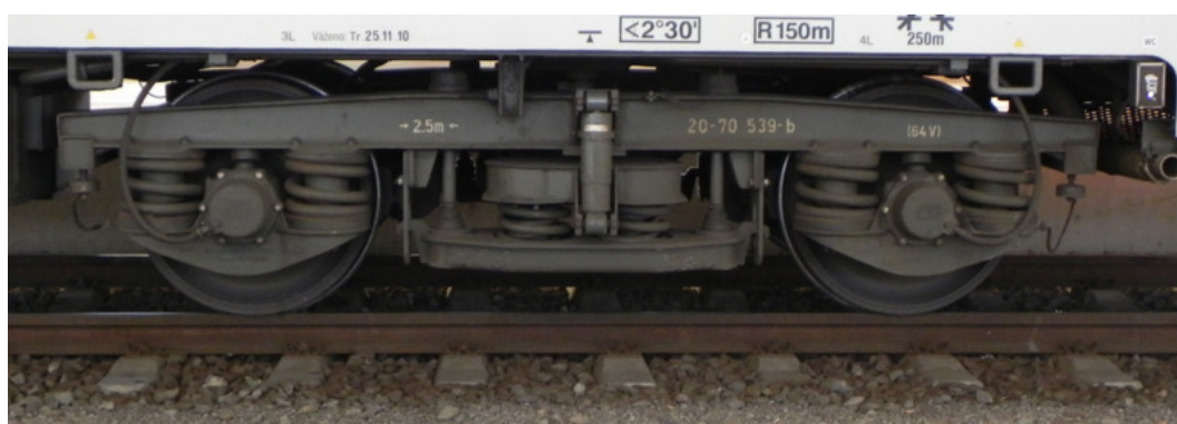
Obr. 27. Podvozek Görlitz V/Dunakeszi zavázaný pod vozem řady Bee Českých drah (ČD)
