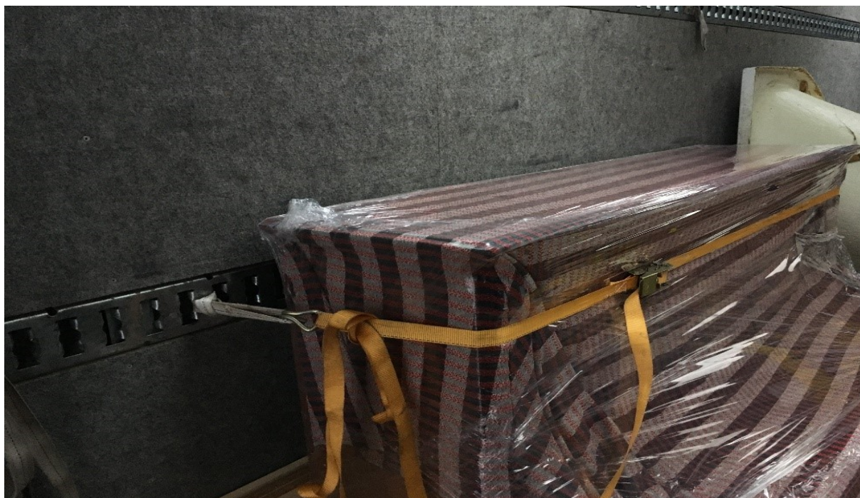
Obrázek 7– Příklad přepravního balení pomocí deky a smršťovací fólie
