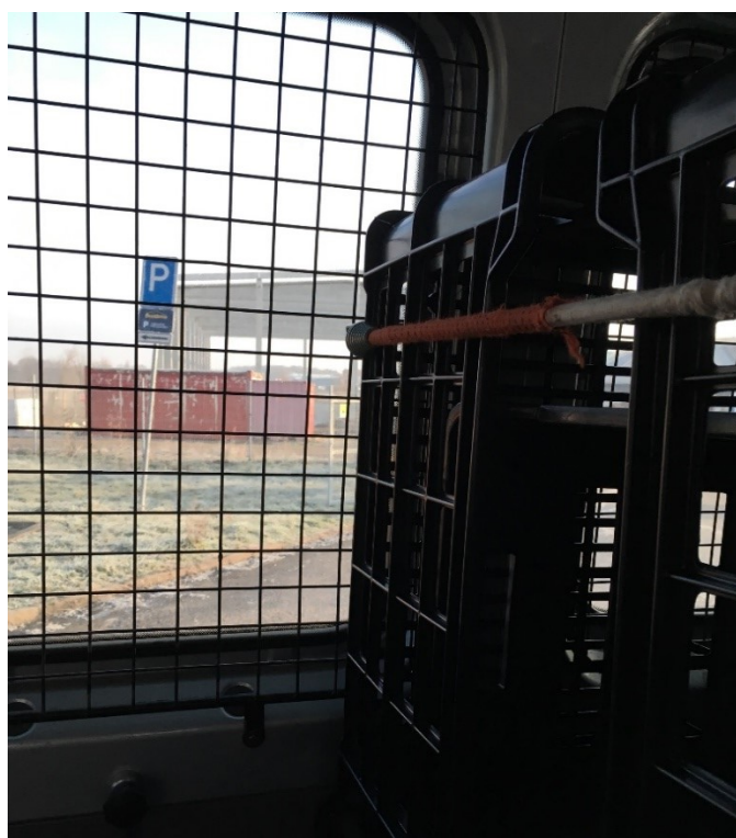
Obrázek 1- Fixace přepravek v nákladním prostoru VW Crafter
