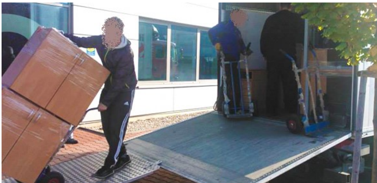
Obrázek 2 – Sklápěcí čelo prodloužené nastavnou plošinou
