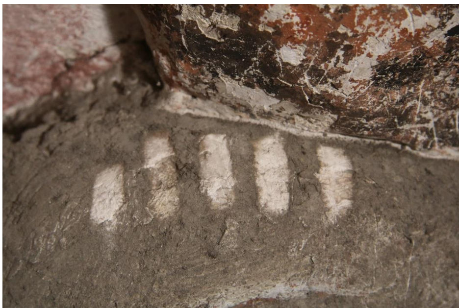
Obr. 3 Zkoušky čištění prachového depozitu na křídovém podkladu. Zleva: štětec, plastická guma, tvrdá obyčejná guma, wishab houba měkká, wishab houba střední.
