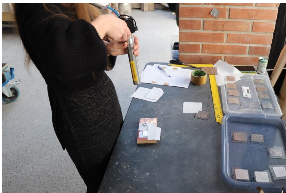
Obr. 37 Proces čištění plátek pomocí laseru, vzorek je zakryt dvěma papíry pro zajištění viditelného přechodu mezi neošetřenou částí vzorku
