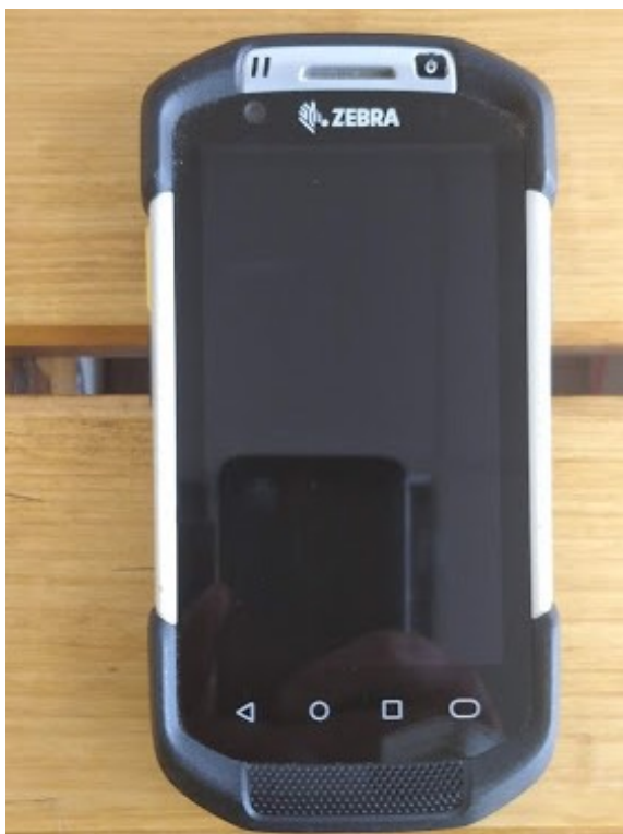
Obrázek 4 Mobilní terminál Zebra TC51, určen pro skenování zásilek (autor, 2020)
