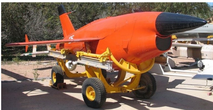
Obrázek 6 Průzkumný bezpilotní prostředek Ryan AQM-34 Firebee na mobilním přepravním podvozku. (AFAHC, 2025) Upraveno
