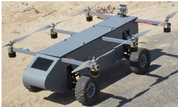
Obrázek 12 Hybridní dron se čtyřmi koly a šesti rotory pro pohyb na zemi i ve vzduchu (Dinelli a spol., 2023)
