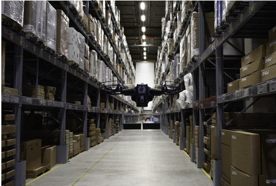
Obrázek 50 dron společnosti Verity provádí inventarizaci zboží ve skladu bez nutnosti lidského zásahu. (Verity, 2022)
