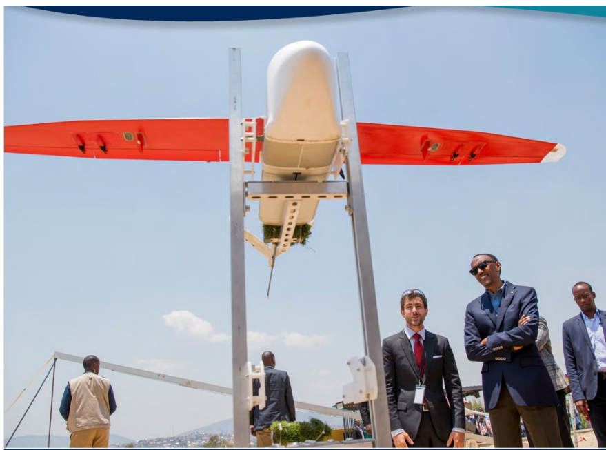
Obrázek 48 dron společnosti Zipline připravený na start z katapultu během návštěvy představitelů Muhanze (Rwanda) (Zipline, 2016).
