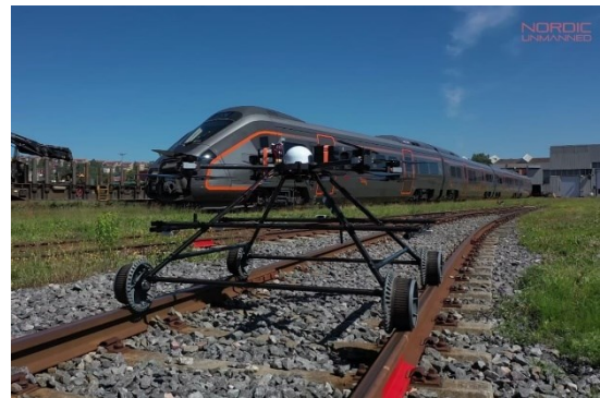
Obrázek 13 Hybridní inspekční dron Staaker BG-300 určený pro jízdu po kolejích a let (Holloway, 2021)
