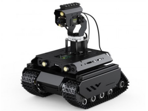
Obrázek 15 Pozemní dron s pásovým podvozkem, vybavený senzorovou hlavicí (Waveshare, 2024)
