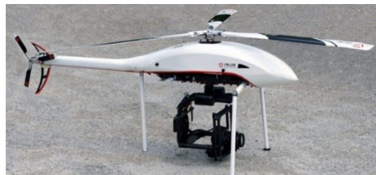
Obrázek 32 Jedno rotorový dron s vyrovnávacím ocasním rotorem (Dinelli a spol., 2023).
