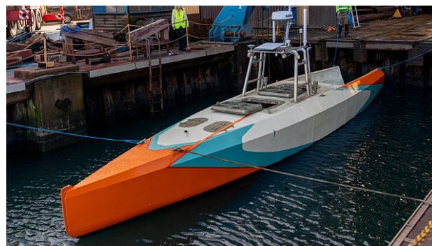
Obrázek 14 Hladinový dron určený pro dálkový dohled bez přítomnosti posádky (Baird Maritime, 2024)
