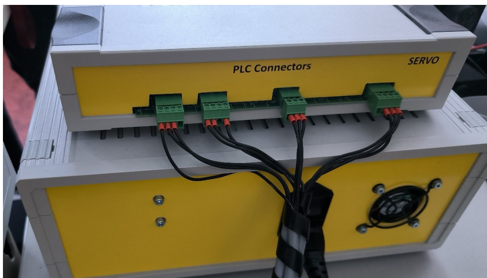
Obrázek 2 - Zadní panel výkonové jednotky Inteco s konektory PLC Connectors
