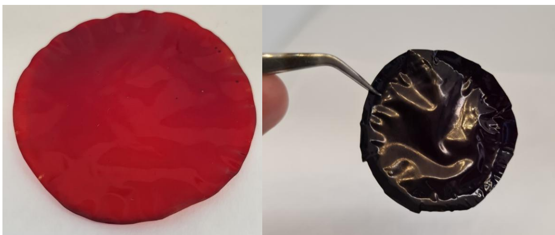
Obrázek 11: Film připravený ze směsi jablečného pektinu a PVA s přídavkem 0,3 % kyseliny karmínové před (vlevo) a po (vpravo) expozici parám amoniaku [foto autor]
