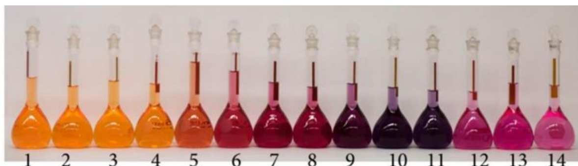
Obrázek 5: Změna barvy roztoku kyseliny karmínové v závislosti na pH (pH 1–14) [44]
