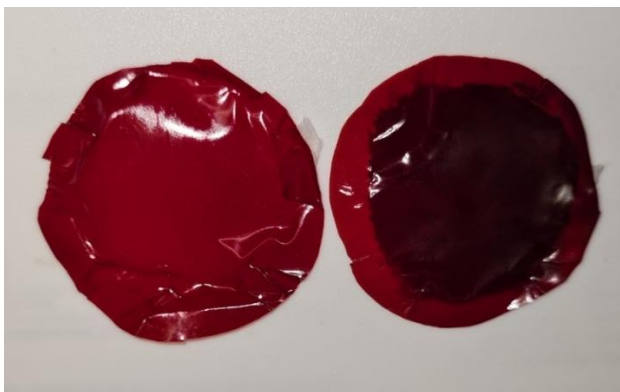
Obrázek 15: Film připravený ze směsi citrusového pektinu a PVA s přídavkem 0,3 % kyseliny karmínové před (vlevo) a po (vpravo) expozici těkavým látkám vznikajícím při kažení masa [foto autor]
