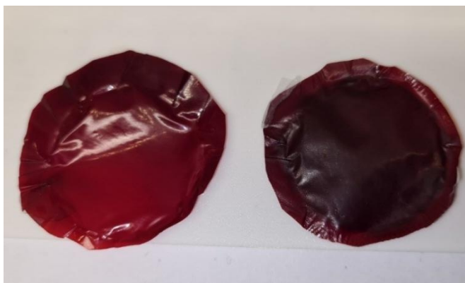
Obrázek 13: Film připravený ze směsi jablečného pektinu a PVA s přísávkem 0,3 % kyseliny karmínové před (vlevo) a po (vpravo) expozici těkavým látkám vznikajícím při kažení masa [foto autor]
