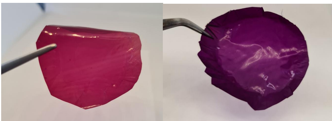
Obrázek 12: Film připravený ze směsi citrusového pektinu a PVA s přídavkem 0,1 % kyseliny karmínové před (vlevo) a po (vpravo) expozici parám amoniaku [foto autor]
