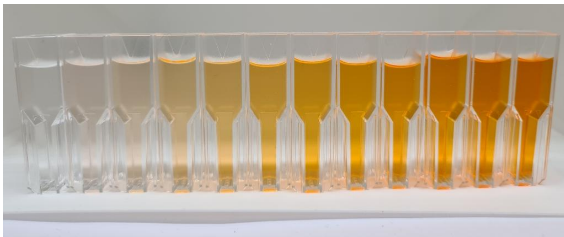
Obrázek 16: Kalibrační roztoky kyseliny karmínové v koncentračním rozsahu 0–100 mg/l [foto autor]
