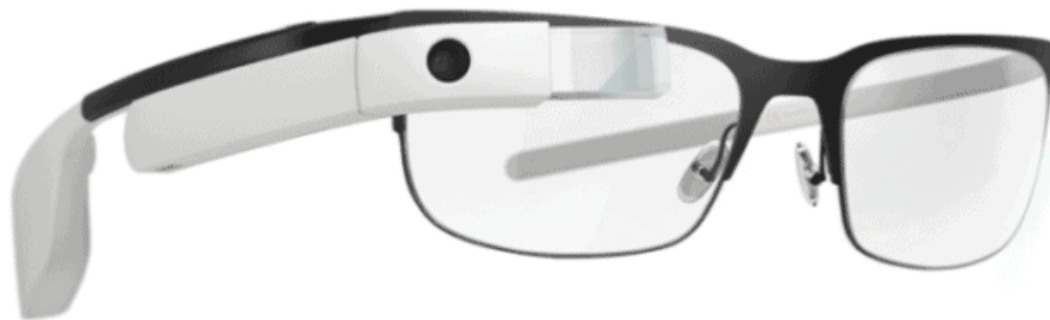
Obrázek 5 Brýle pro vychystávání pomocí Pick by Vision (LUCA, 2023)
